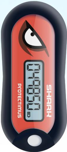
Protectimus Two и Protectimus Shark — это прочные, водостойкие аппаратные TOTP токены с заранее установленными секретными ключами, которые нельзя перепрограммировать.
